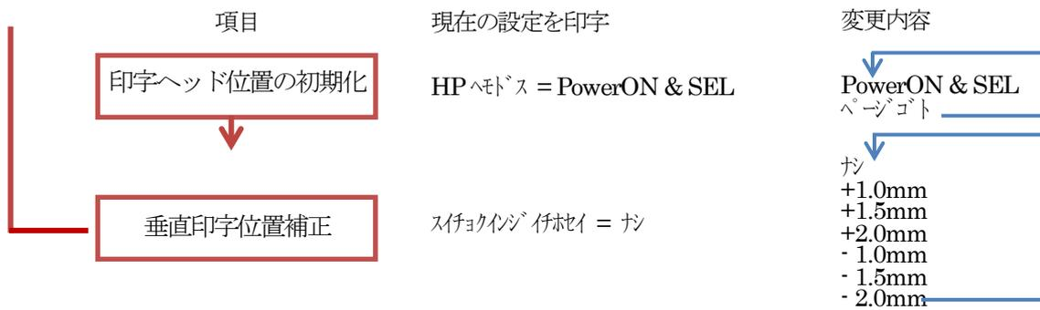
変更が終わったら印刷可 SW と紙送り SW を同時に押します。(どの項目の後でも可)
