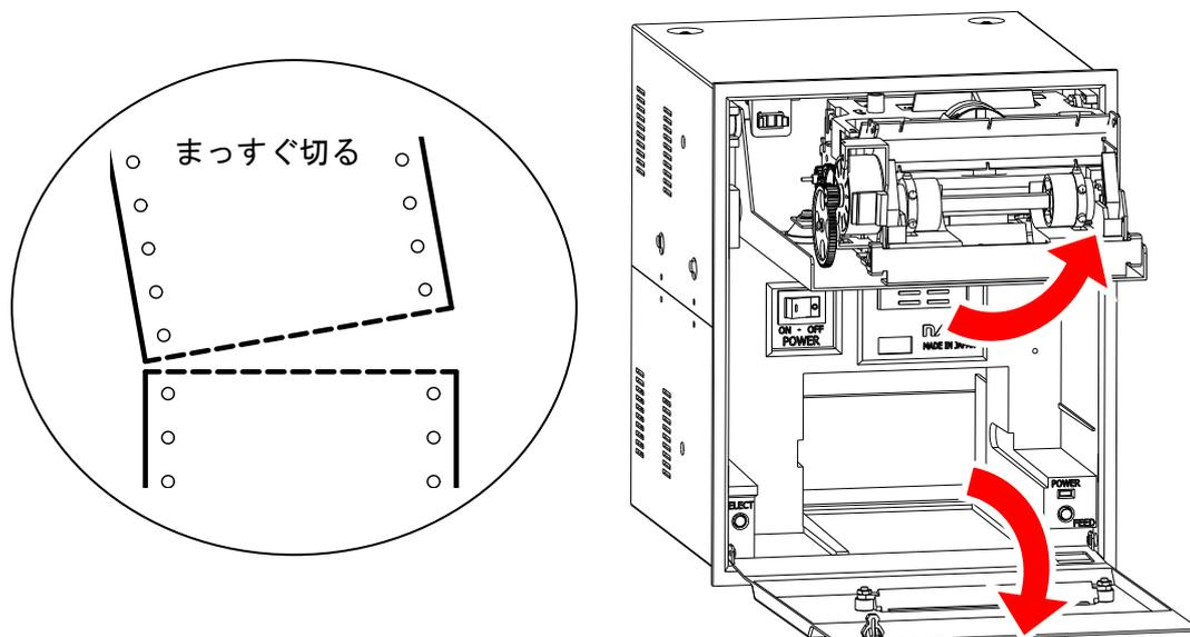
2. セットした用紙をプリンタメカの用紙ガイドに挿入し、紙送りノブを手で矢印の方向に回すかまたはフィードスイッチを押して紙送りを行い、用紙の左右の穴にスプロケットのピンを確実に噛み合わせます。
