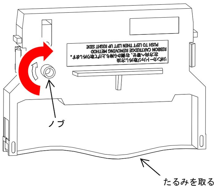
4. リボンカートリッジのリボンを印字ヘッドとリボンマスクの間に入れてから、リボンカートリッジを押し込むとセットされます。
