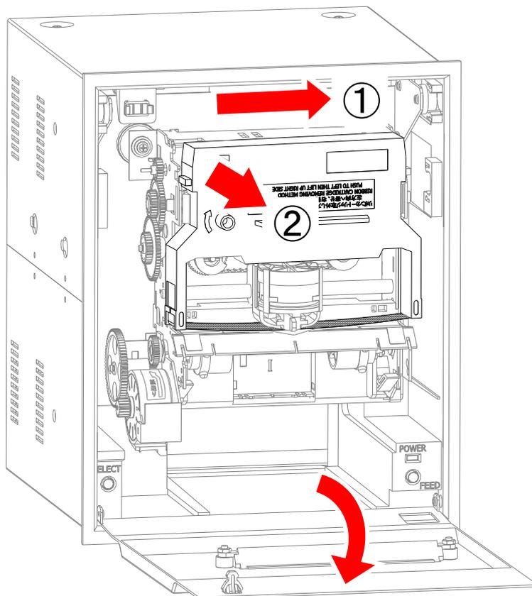
3. 新しく取付けようとするリボンカートリッジのノブを、矢印の方向に数回まわしてリボンのたるみをとります。
